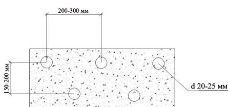
Гидроизоляция "Пенетрон" (2 слоя)
